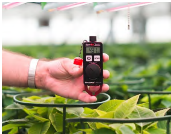
شکل ۵- یک دستگاه پارمتر برای اندازه گیری نور درک شده توسط گیاه
